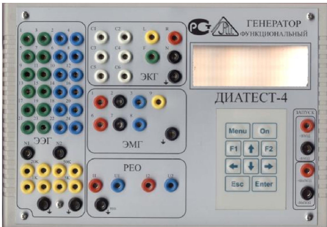
Рис. 2.1. Схема размещения разъёмов и лицевая панель генератора
