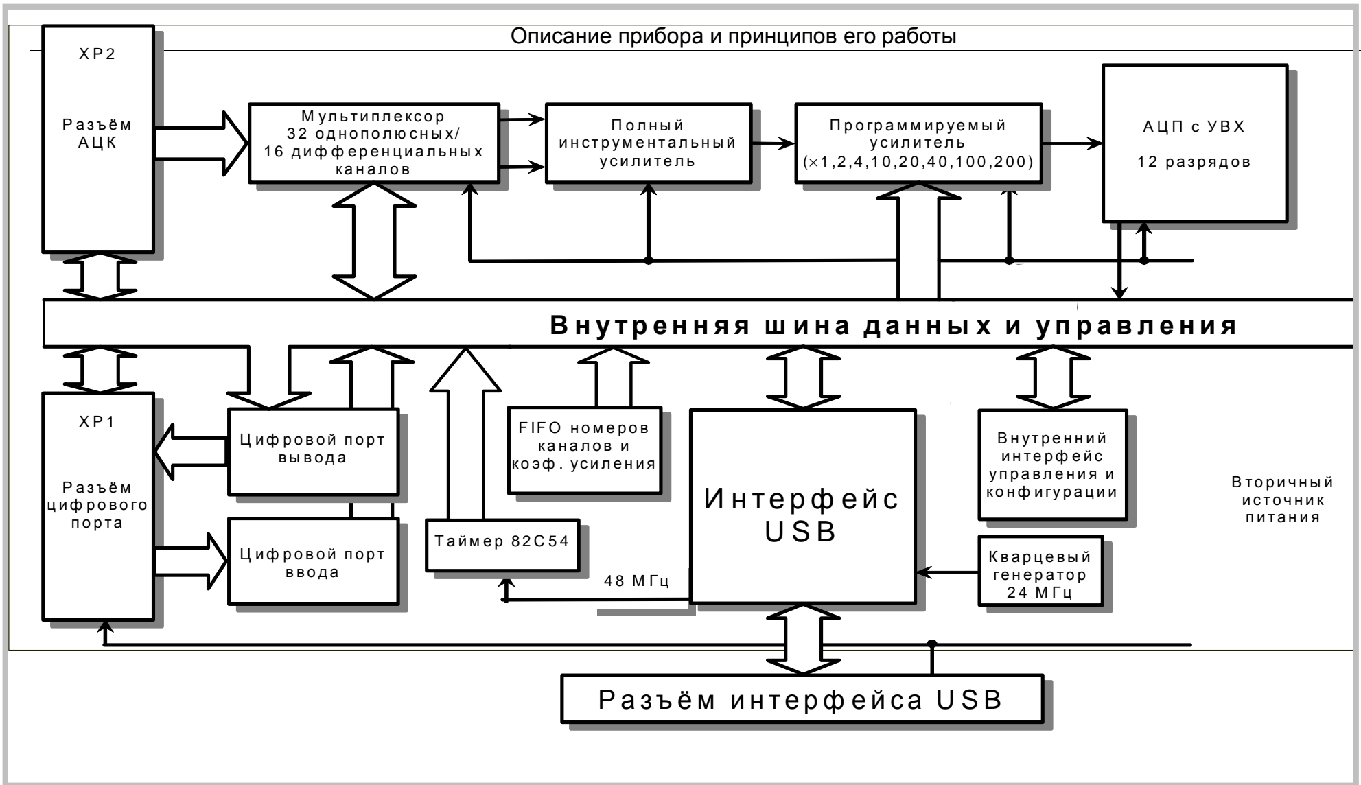
Функциональная схема ЛА-2USB
